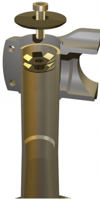
Obr. 1: Odskrutkujte hviezdicovú maticu z hornej časti riadiacej rúrky
